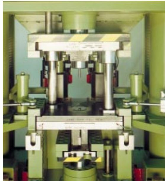
1a) Einbausituation Werkzeug mit aut. Spannung
