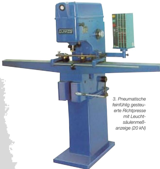
3. Pneumatische feinfühlig gesteuerte Richtpresse mit Leuchtsäulenmeßanzeige (20 kN)
