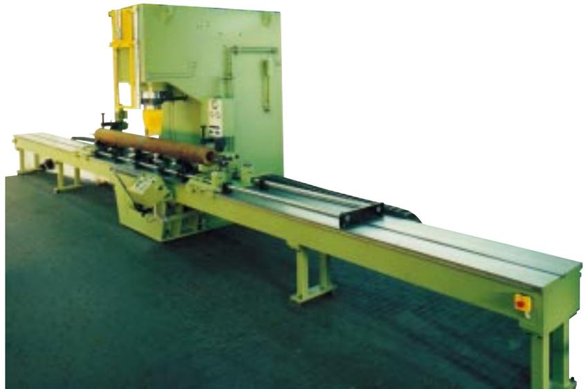
6. Richtanlage mit Handhebelsteuerung, motorischem Fahr- und Drehtrieb, 1000 kN
