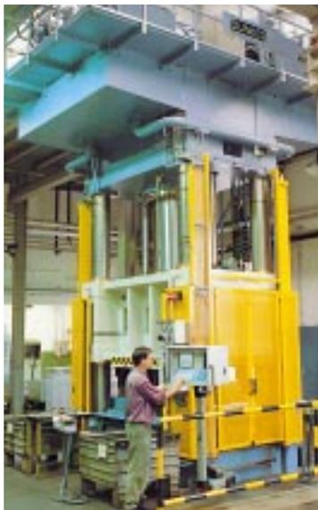
5. Doppelständerpresse mit 4fach-Schnittschlagdämpfung 4000 kN
