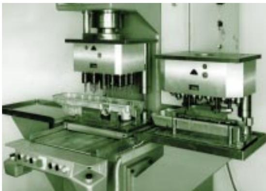
4. Einständer-Taumelnietmaschine mit Mehrspindel-nietkopf und Werkzeugwechsel (100 kN)
