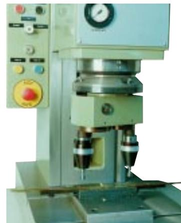
8. DUNKES-Präzisions-Taumelnietmaschine mit Mehrspindel-nietkopf (20 kN)
