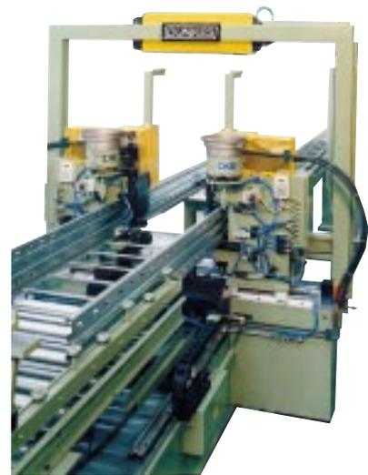
8. Automatische Nietanlage mit 12facher Krampenzuführung für Armaturen Brett
