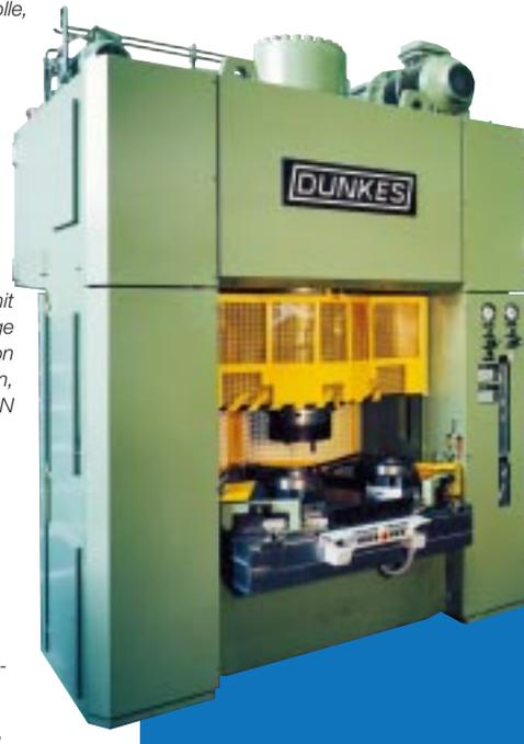
4. Doppelständerpresse mit V-Schiebetisch zur Montage und Kalibrierung von Statorpaketen, Preßkraft 4000 kN
