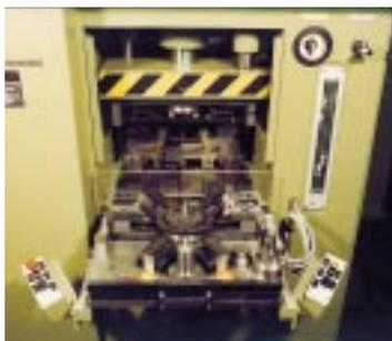
Vollautomatische Abläufe, Fertigungsinseln oder Zellenfertigung werden durch die Variantenbauweise des DUNKES-Programms ermöglicht. Wichtige Aspekte der Bewertung für die jeweilige Fertigungslösung bilden Ihre Ausgangsdaten, z.B. Werkzeugwechsel, Stück/min., Materialfluß, automatisches Be- und Entladen, Programmieraufwand für die werkstück- und werkzeugspezifischen Daten usw.
