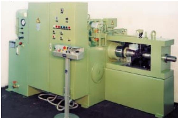
12. Doppelständerpresse mit Schiebetisch, säulengeführter Stößelplatte, 250 kN
