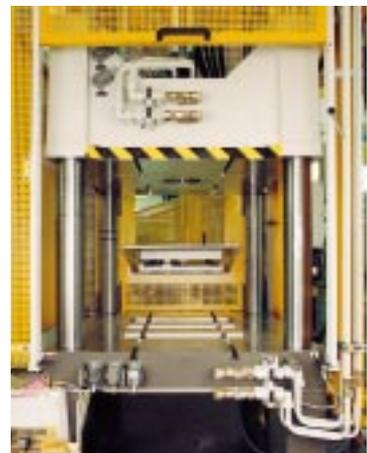
2c) hydraulische/elektrische Anschlüsse für Seitenschieber
