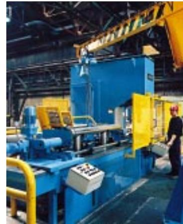
2. Richtpresse mit feinfühlinger Handhebelsteuerung, motorisch verfahrbarem Richtwagen, motorischem Drehantrieb und automatischer Beladestation, 1600 kN
