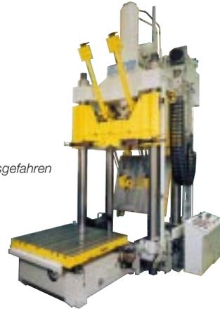
1. 4-Säulen-Tuschierpresse mit ausfahrbarer Tischplatte, 180° schwenkbarer Stößelplatte und 45° wechselseitig kippbarer Tischplatte, Preßkraft 2500 kN
