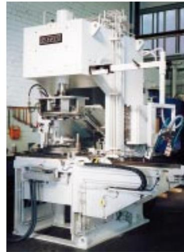
3. Einständer-Entgratpresse mit Schiebepipptisch, Ausblasstation, Gießteilentnahme, 250 kN
