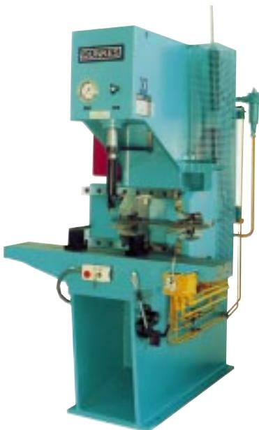
9. Detail Richtpresse mit Drehtrieb, Steuerpult, 630 kN
