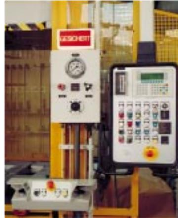
2a) Detail NC-Steuerung und Preßkraftanzeige über Manometer
