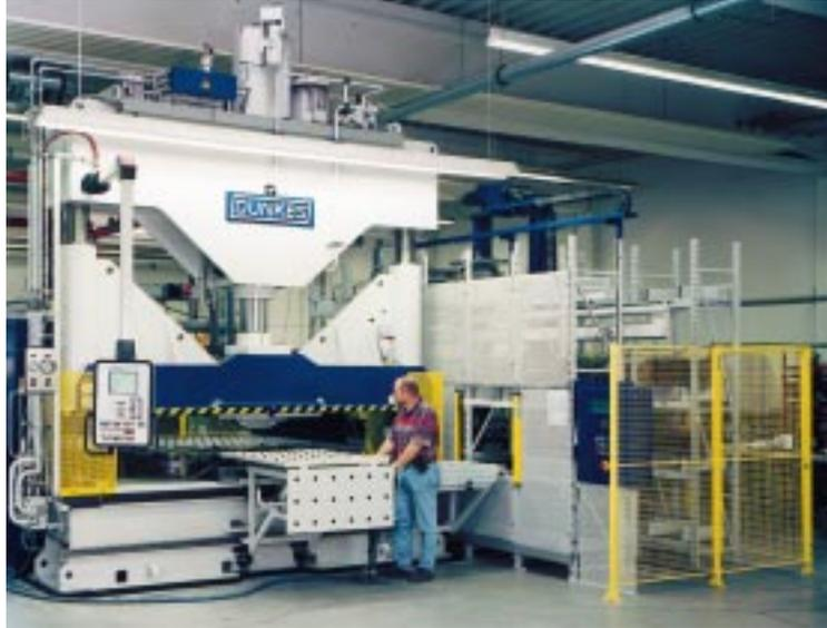
1. 2-Säulen-Stanzpresse mit automatischem Werkzeugwechselregal sowie Werkstückhandling, 1600 kN
