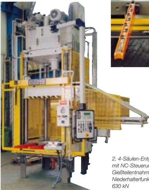
2. 4-Säulen-Entgratpresse mit NC-Steuerung, Gießteilentnahme, Niederhalterfunktion usw., 630 kN
