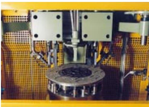
9. Detail drückendes Nietverfahren mit automatischer Nietzuführung
