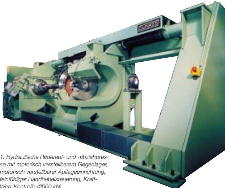
1. Hydraulische Räderauf- und -abziehpresse mit motorisch verstellbarem Gegenlager, motorisch verstellbarer Auflageeinrichtung, feinfühlinger Handhebelsteuerung, Kraft-Weg-Kontrolle (2000 kN).
