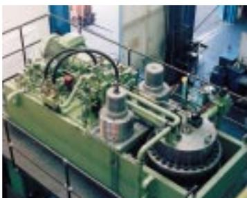
4b) Hydraulischer Antrieb/ Zugankerbauweise
