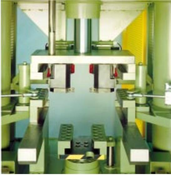
1c) Einbauraum ohne Werkzeug mit hydraulischen Werkzeugspannleisten
