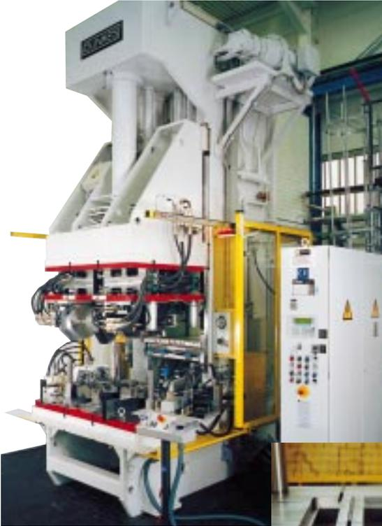
1. Einständer-Entgratpresse mit NC-Steuerung, hydraulischen Seitenschiebern, Lichtschranke, Gießteilentnahme, Niederhalterfunktion usw., 320 kN.
