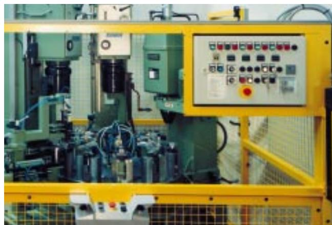
3. Rundschartellernietanlage mit 6 Stationen, mechanisch schaltendem Rundscharteller, Prüfstation für Niethöhe, Kraft-Weg-Kontrolle und Werkstückspannung (20/40 kN Nietkraft)
