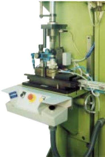
11. Einständerpresse mit Handhebelsteuerung und servogeregelter Stößelachse, 3150 kN
