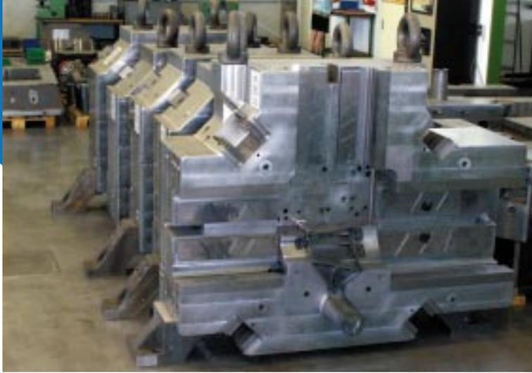
Druckgüßformen für Mercedes-Benz Getriebegehäuse. Formgewicht 22 Tonnen.
