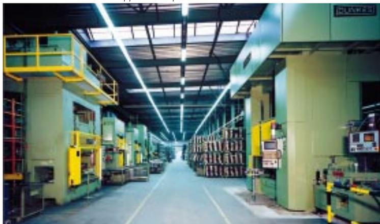
4. Pressenlinie 1000 - 4000 kN mit Werkzeugwechselregal/Bandanlage
