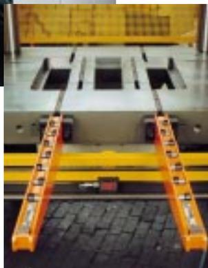
2b) Tragarme für Werkzeugwechsel
