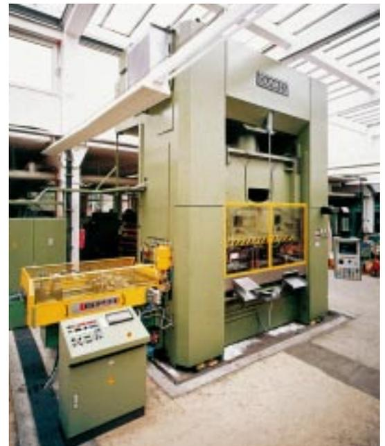
2. Doppelständer-Stanz- und Ziehpresse mit Transfereinrichtung, 4000 kN
