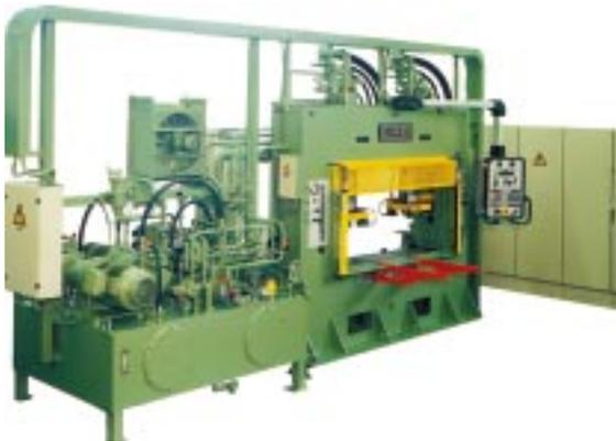
6. Rahmenpresse mit 2 gesteuerten Zylindern je 250 kN
