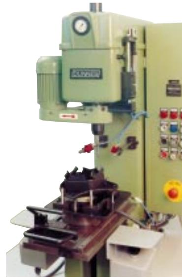
2. Taumelnietmaschine mit Schiebetisch, Kraft-Weg-Kontrolle (20 kN)
