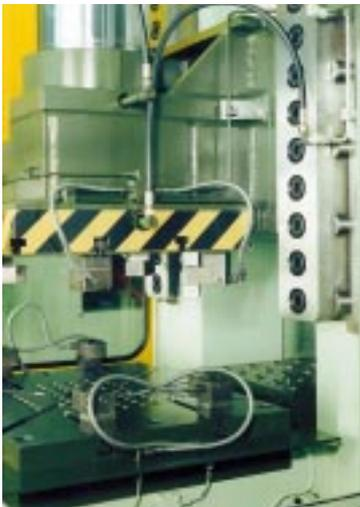
1b) Prismengeführter Stößel mit hydraulischer Werkzeugspannung
