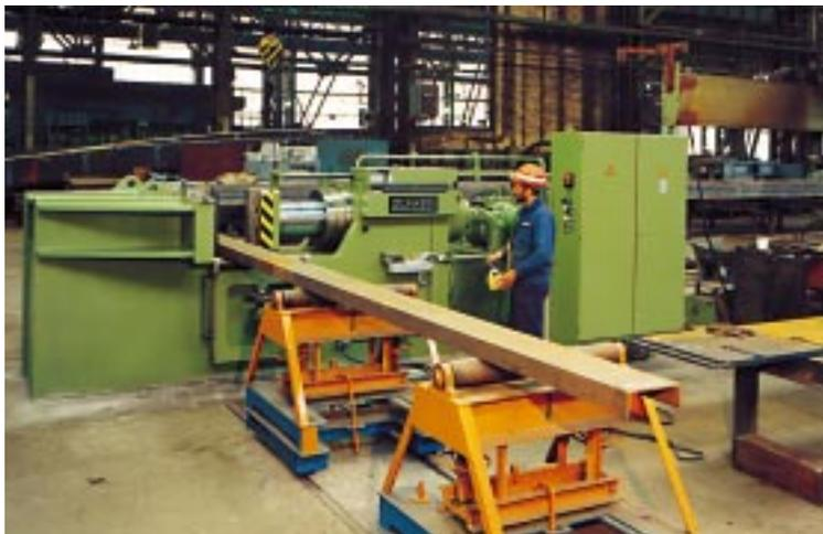
3. Waagrecht-Richtpresse mit feinfühlinger Handhebelsteuerung einschließlich Rollenböcke für Profile, 3150 kN
